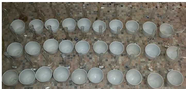
19. ábra: A magnéziumtartalom feltárása az algaminták izzítása után visszamaradt hamuból savas hidrolízis módszerrel
