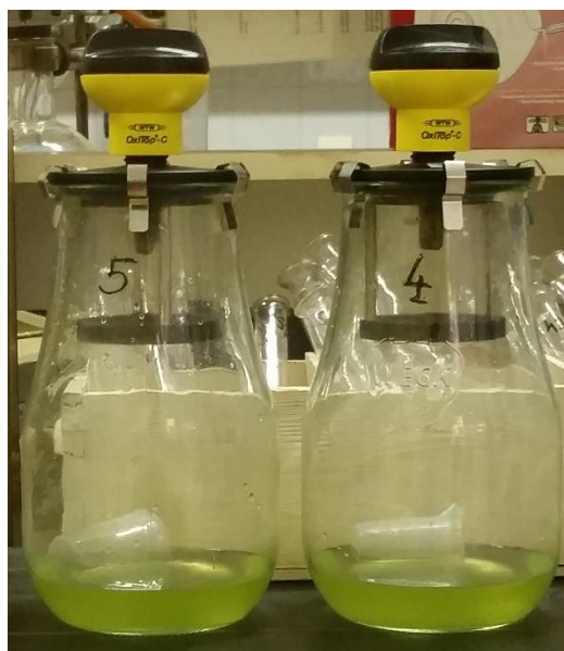
26. ábra: Az oldott szervesen széntartalom meghatározása az OxiTop készülékek használatával
