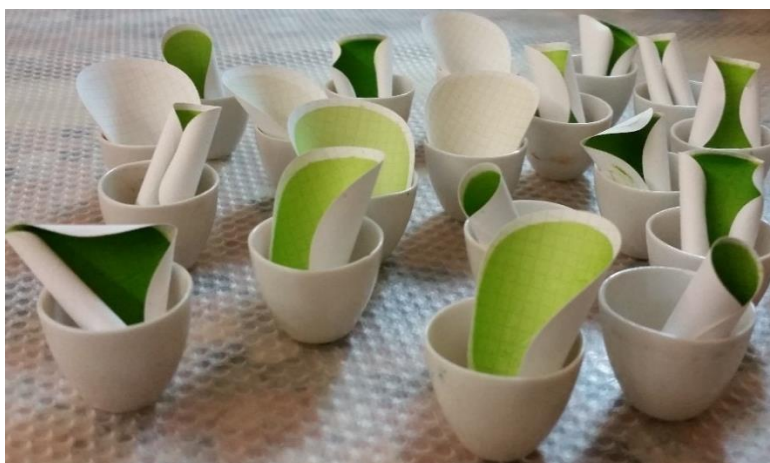
17. ábra: Az algabiomassza szűréssel történő meghatározása
