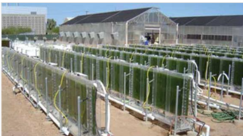
7. ábra: A sík paneles fotobioreaktorok elrendezése (BWATANGLANG et al. 2015)
