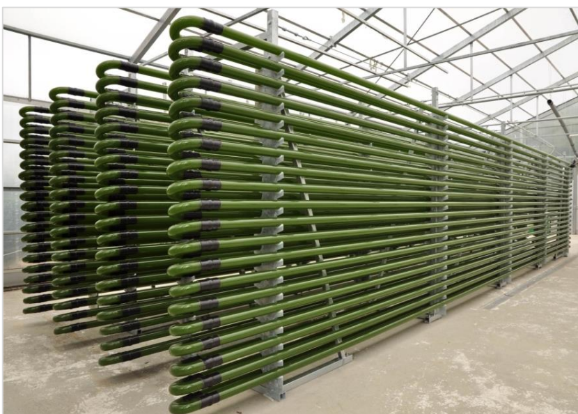
8. ábra: A fektetett csöves fotobioreaktorok elrendezése (RAUT et al. 2015)
