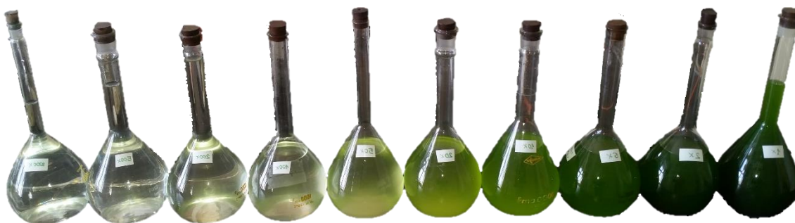
16. ábra: A alga-törzstenyészetből előállított hígítási sor
