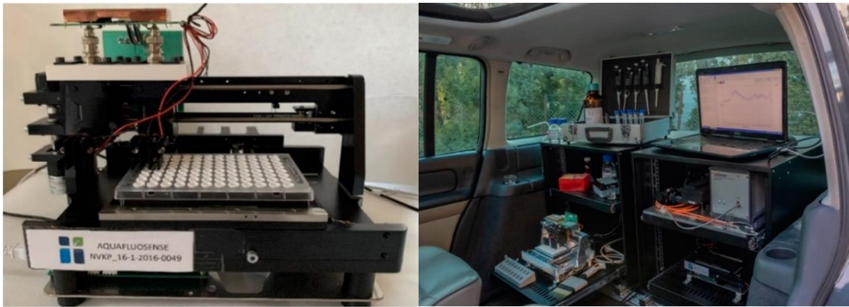
6. ábra: Az Aquafluosense projekt keretein belül fejlesztett műszercsalád fluorimétermodulja (balra) és az eszköz terepi alkalmazáshoz gépjárműbe szerelve (jobbra).
