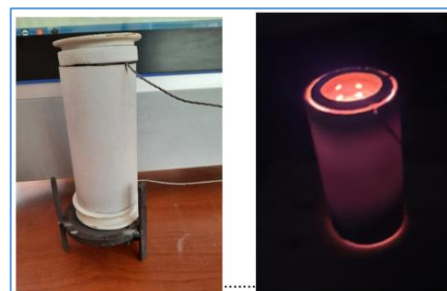
6. ábra Direkt módon elektromos fűtésű, légbevezetésre alkalmas laborreaktor, maximális működési hőmérséklet: 1300 °C (MATE labor)
