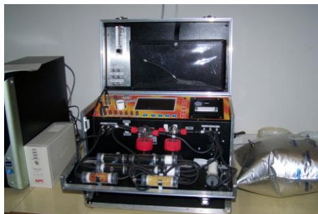
3. ábra VISIT 03H gázelemző berendezés (MGI labor)
