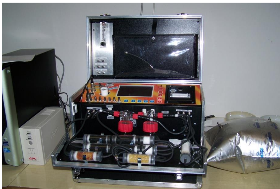
24. ábra VISIT 03H gázelemző berendezés (MGI labor)
