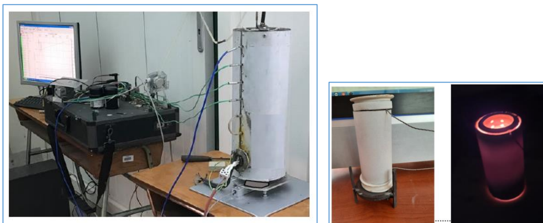
27. ábra Direkt módon elektromos fűtésű, légbevezetésre alkalmas laborreaktor, maximális működési hőmérséklet: 1300 °C (MATE labor)
