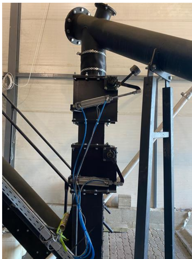
7. ábra: Tüzelőanyag betöltő zsilipek (saját ábra)
