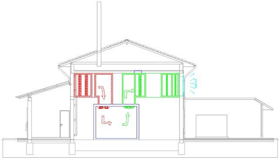
16. ábra Gázmotoros erőmű telepítése Berekfürdön a termálkút kísérőgáz felhasználására
