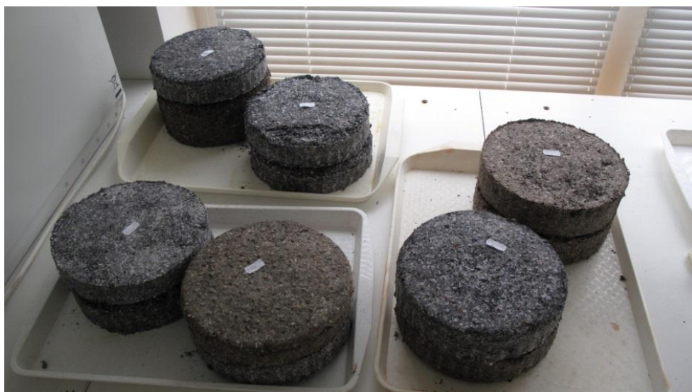
1. fotó: Különböző arányokban elkészített biomassza-kokszt fűtőtégla
