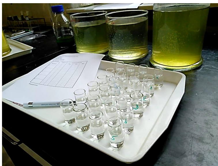
2. ábra Akut immobilizációs vizsgálat Daphnia magna tesztszervezeten (saját fotó)
