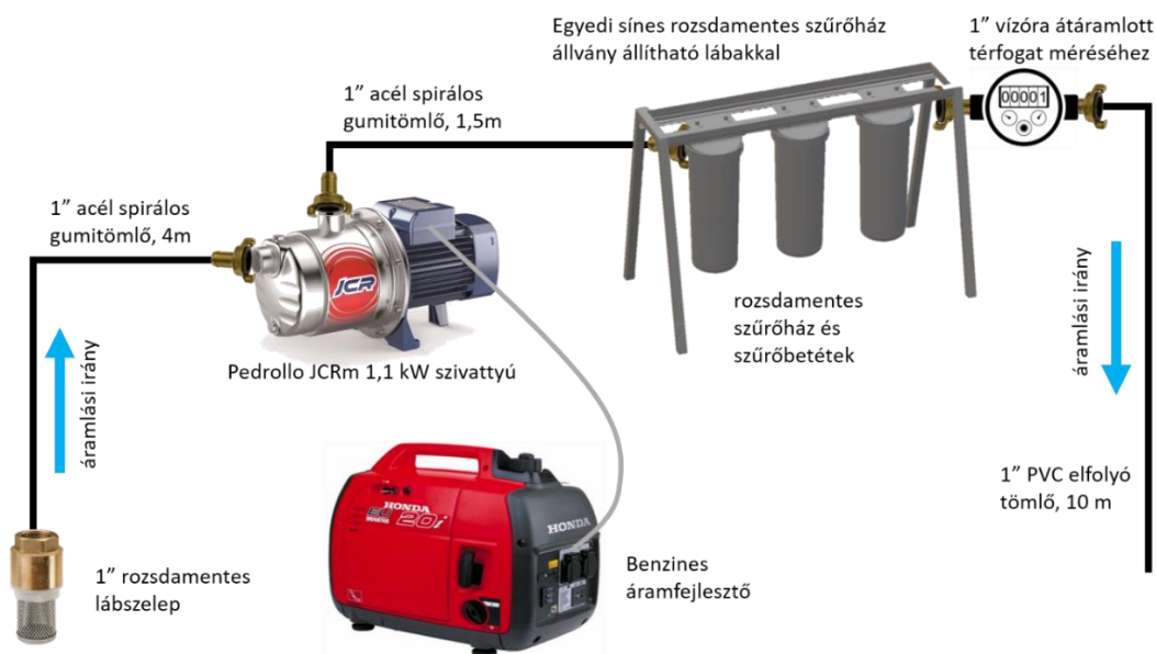
2. ábra: Szűrőhatékonyság terepi tesztelése és mintavételi hatékonyság üzemi tesztelése során használt, fejlesztett mintavevő rendszer.
