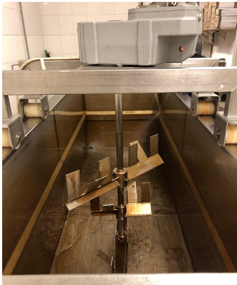
17.ábra: A mikroműanyagok visszanyerési hatásfokának megállapítására vonatkozó mintavételi kísérletekhez használt tartály és keverő berendezés.
