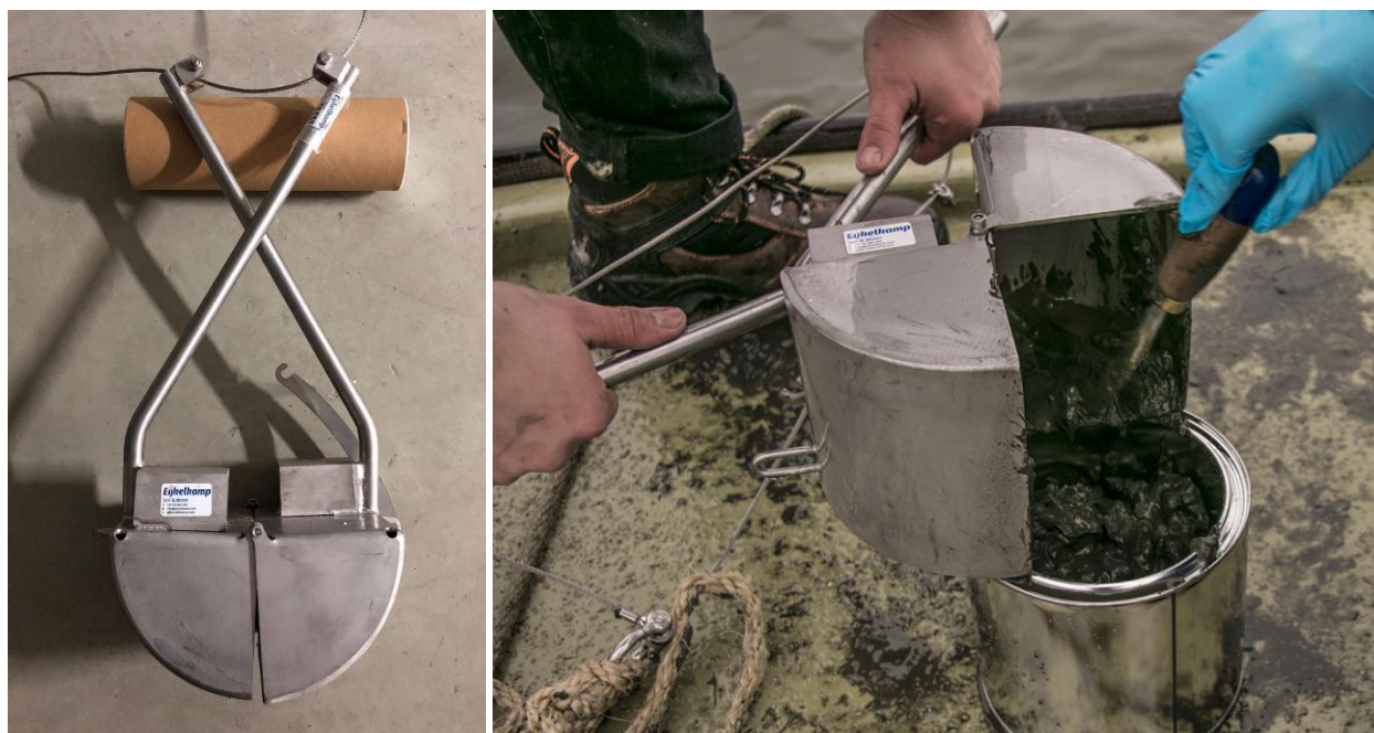
6. ábra: Mederüledék mintázása Van Veen mintavevővel.
