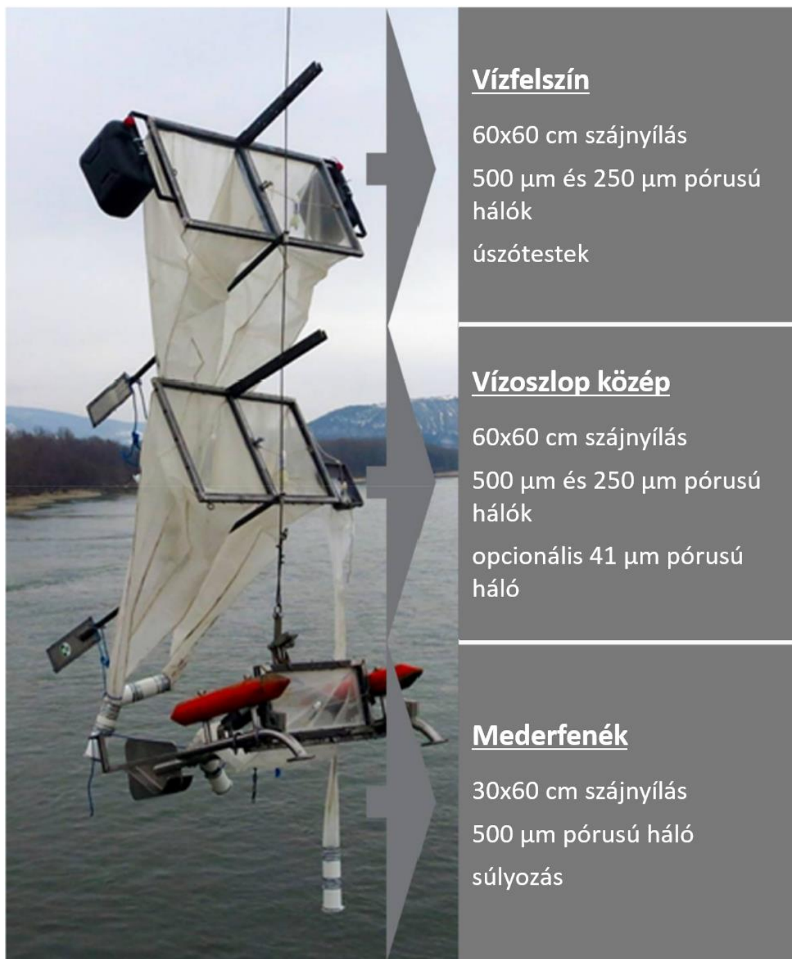
5. ábra: Egyedi kialakítású, többszintű planktonháló folyóvízi mintázáshoz (LIEDERMANN ET AL., 2018).
