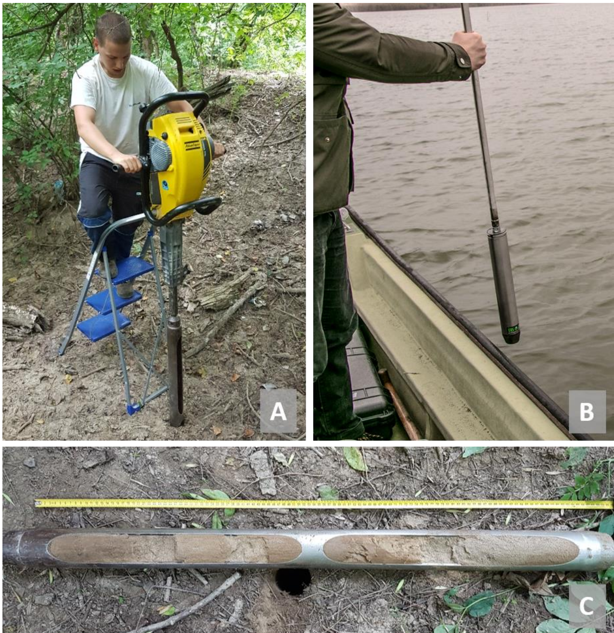
7. ábra: Bolygatatlan magminta gyűjtése vízparti üledékből (A), mederüledékből (B), valamint a mintavétel eredményeként keletkező üledékszervény (C).
