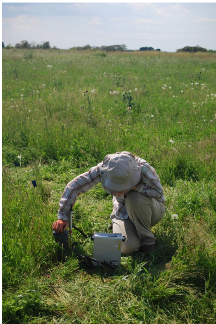
13. kép. A talajlégzés mérése
