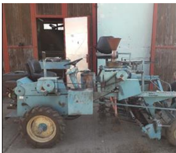
5. ábra. Wintersteiger Plotman típusú parcellavetőgép
