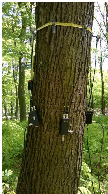
6. ábra: A Q. petraea Fakopp-os mérése (Fotó: Trenyik Petra, 2015)
