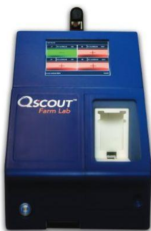
3.5. ábra: A Qsout Farm Lab hordozható diagnosztikus berendezés, amely egy beépített mikroszkóppal vizsgálja a tejmintákat és laboratóriumi minőségű adatokat képes szolgáltatni helyben (a kép forrása: Advanced Animal Diagnostic)
