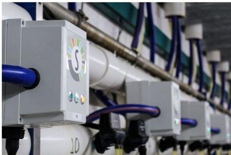
3.6. ábra: A SomaDetect cég érzékelője tejfeldolgozó rendszerbe építve (a kép forrása: SomaDetect)
