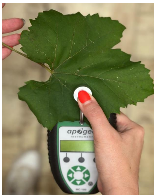
20. ábra: Apogee MC-100 klorofillmérő. Forrás: Saját fotó
