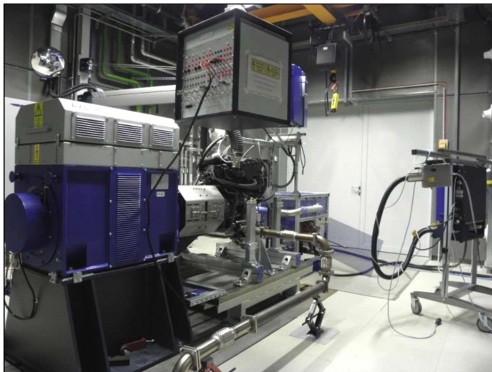
3.21. ábra: AVL PC 220kW motoros fékcella
