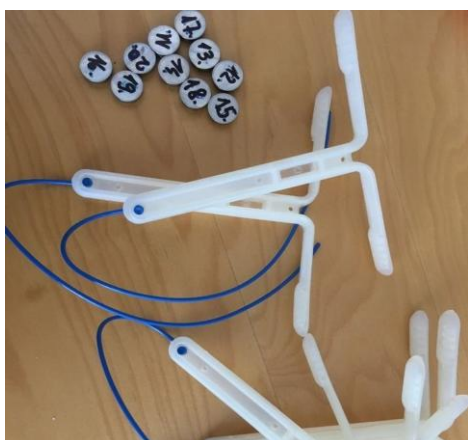
7-8. kép: Az iButton hőmérők és CIDR-ek összeszerelés előtt és után Fotó: Jurkovich Viktor
