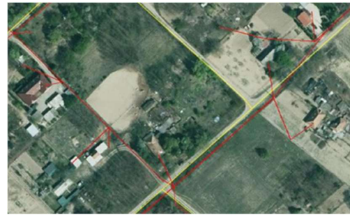
Figure 69. Energy network of discontinuous residential area of Kecskemét ('E-Közmű Lakossági Térkép' n.d.)
