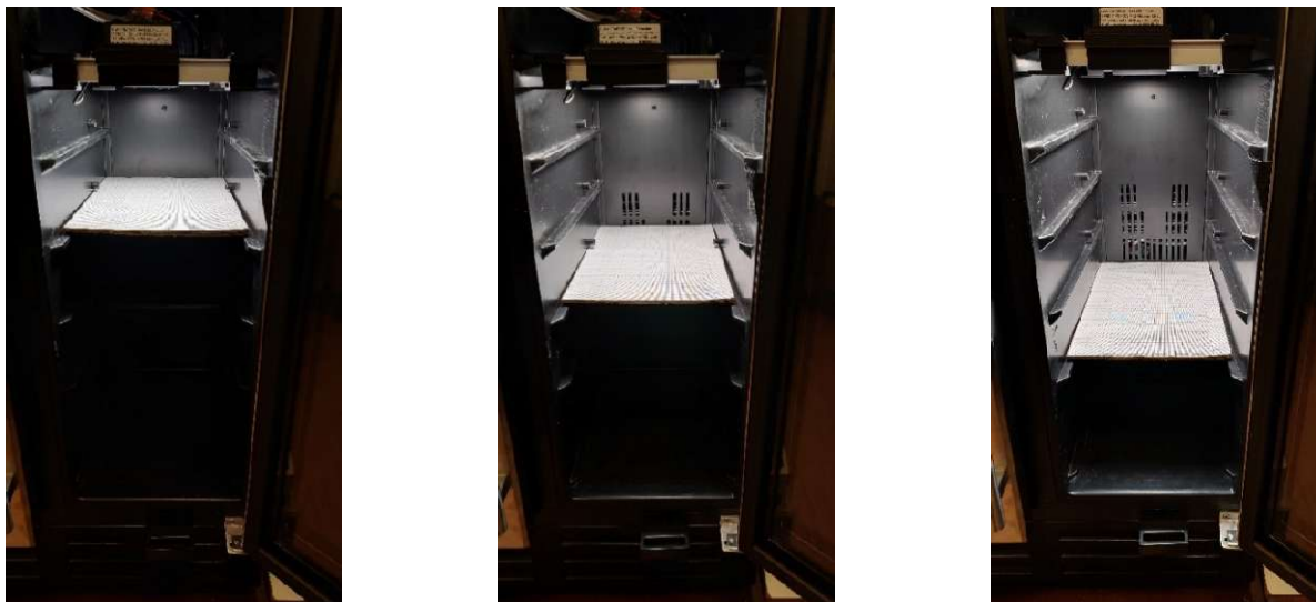
1. ábra. A „Ledium Black Sparkle Modular64 Base” megvilágítású klímakamra jobb kamrájának felső, középső és alsó szintjeire helyezett, vízszintes felületre felvitt mérési rácspontjai (saját fotó)
