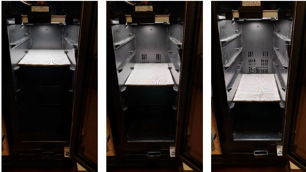
16. ábra. A Ledium Black Sparkle Modular64 Base megvilágítású klímakamra jobb kamrájának felső, középső és alsó szintjeire helyezett, vízszintes felületre felvitt mérési rácspontjai (1–66) (saját fotó)
