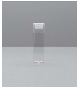
20. ábra. 4 oldalon átlátszó, egyszer használatos, 10 mm fényúttal rendelkező, 45 mm magasságú polisztrén küvetta (saját fotó)
