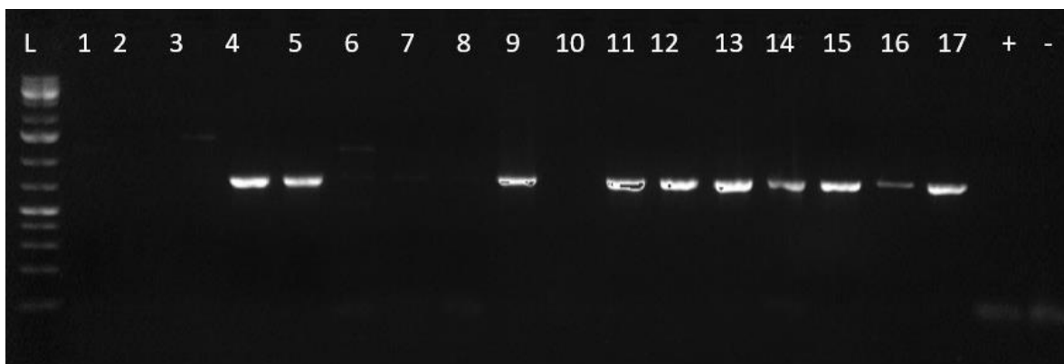
73. ábra: Az AflS génre specifikus primer párokkal kapott PCR termékek 1%-os agaróz gélben, 45 perces futtatási idővel, 10X TBE bufferrel, micéliumos izolátumokból kinyert DNS-sel az 1-17-es mintában, pozitív és negatív kontrollal. 1kb Plus DNA Ladder (Thermo Fisher Scientific) indikációval (L). A várható amplifikációs termék 684 bp. A pozitív kontroll esetében nem amplifikálódott a célszekvencia
