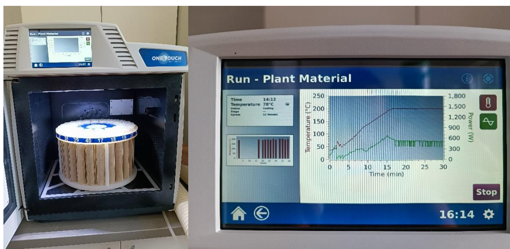
10. ábra Minták roncsolása a ONE TOUCH TECHNOLOGY MARS 6 mikrohullámú készülékben
