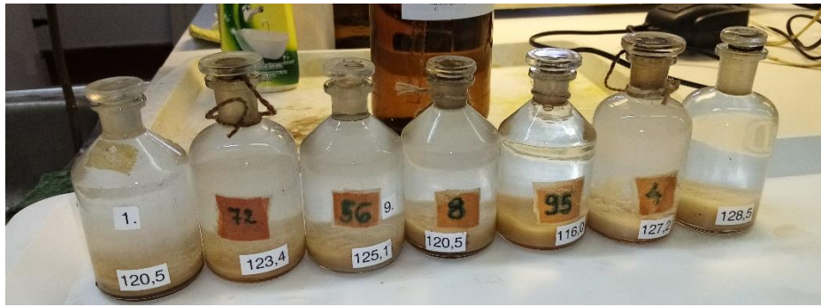
8. ábra Biokémiai oxigénigény (BOI 5 ) meghatározása 5 nap után vízmintából
