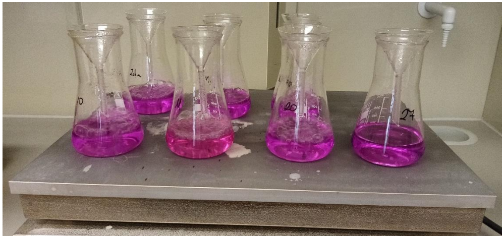
7. ábra Permanganátos kémiai oxigénigény ( KOI_p ) meghatározása
