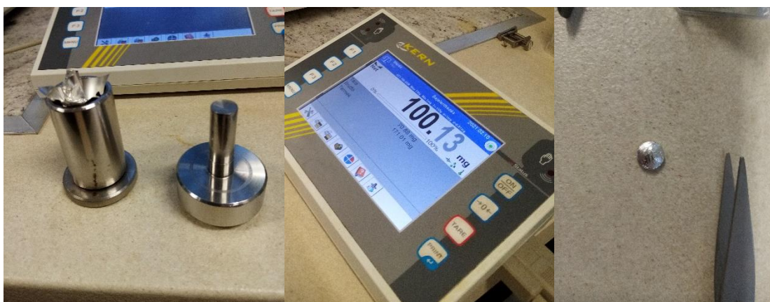
9. ábra Növényi minták bemérése Elementar vario MACRO CUBE típusú elemanalizátorral történő összes szerves szén (TC)– és nitrogén (TN) meghatározásához
