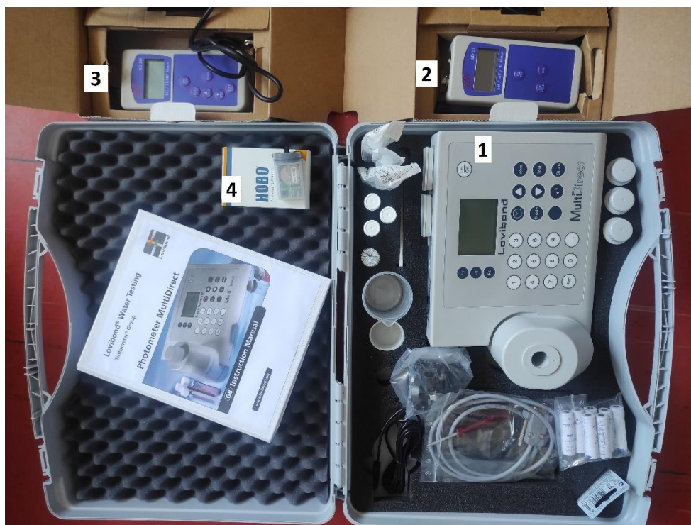
6. ábra A víz fizikai és kémiai tulajdonságainak vizsgálatához használt terepi műszerek: 1. 0913462 típusú Lovibond MultiDirect spektrofotométer (NH 4 -N, PO 4 -P, SO 4 -S meghatározása); 2. Adwa AD111 típusú műszer (pH meghatározása); 3. AD310 típusú műszer (EC meghatározása); 4. HOBO UA-002-64 típusú adatgyűjtő (T w in situ meghatározása 10 perces mintavétellel)
