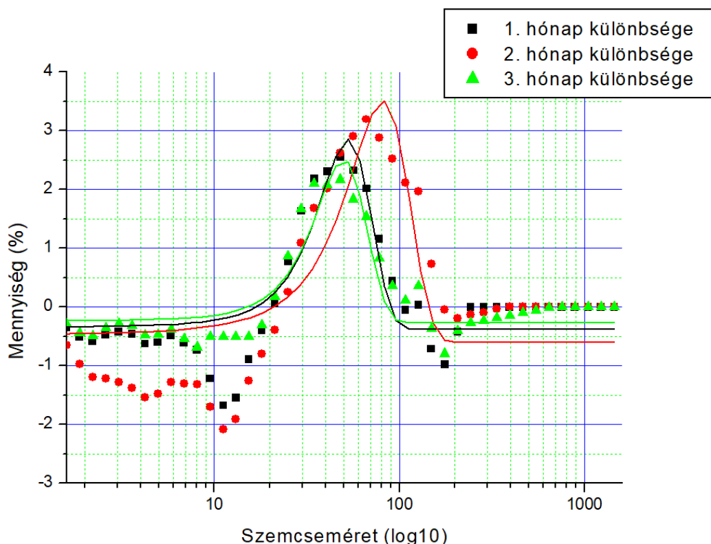
34. ábra: A Karcag-B minta (Réti szolonyec) szemcseméret-eloszlásának különbsége a 0. hónap eredményéhez viszonyítva (abból kivonva), gauss illesztésű függvényekkel
