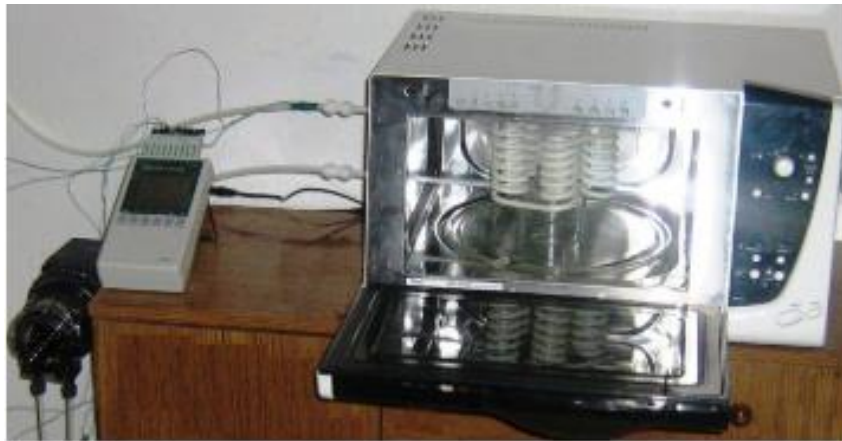
Fig. 2.5. Microwave milk pasteurization (Korzenszky et al., 2013).
