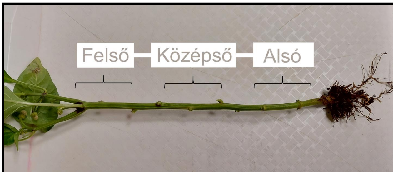
20. ábra: A szár különböző részeinek meghatározása mintavételhez a lignintartalom és mechanikai tulajdonságok értékeléséhez
