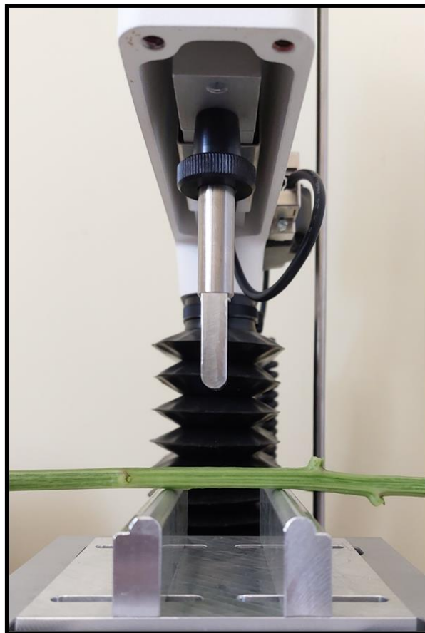
21. ábra: Mechanikai 3-pont töréssel alkalmazása textúra analizáló géppel paprikaszár esetében
