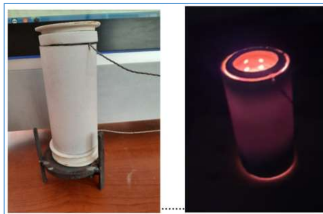
41. ábra A készülékből kisserelt fűtőtest és az 1000 °C-ra felfűtött állapota.
