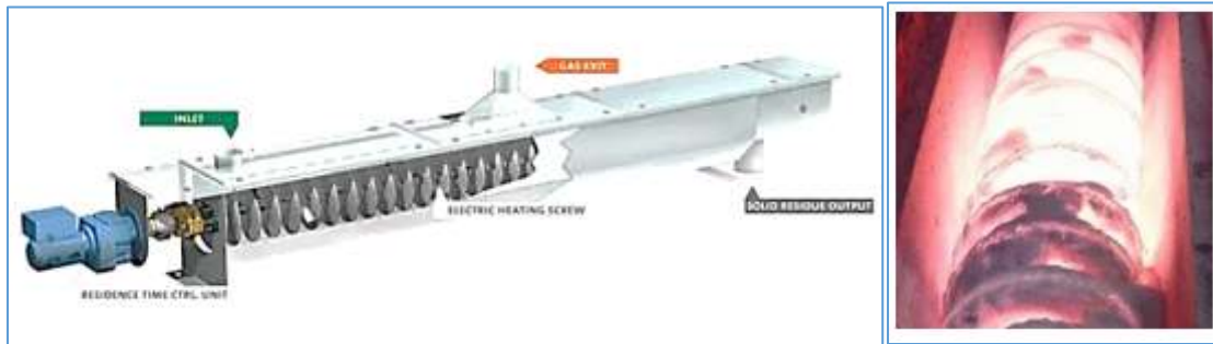
11. ábra Csigás reaktorról rendelkező megoldás 5
