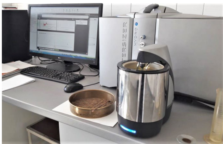
3. ábra. A Mastersizer 3000 készülék a Hydro LV előkészítő egységgel üzemeltetve (HUN- REN TAKI, saját felvétel)
