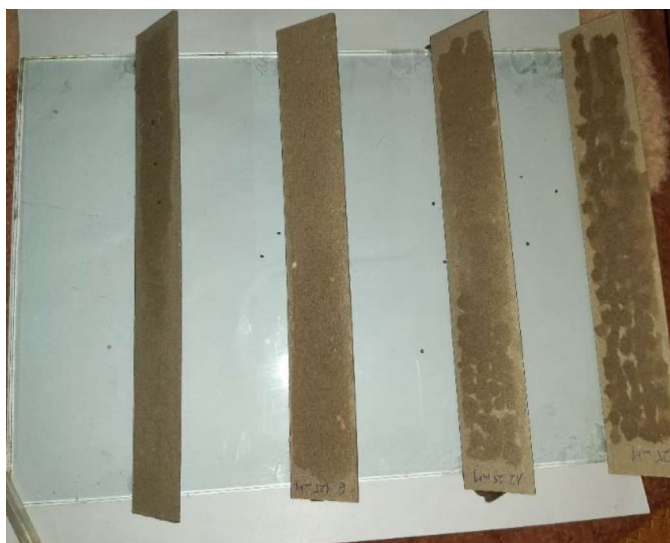
8. ábra Különböző töménységű lítium-kloriddal átitatott kartonlapok (Forrás: saját kép)
