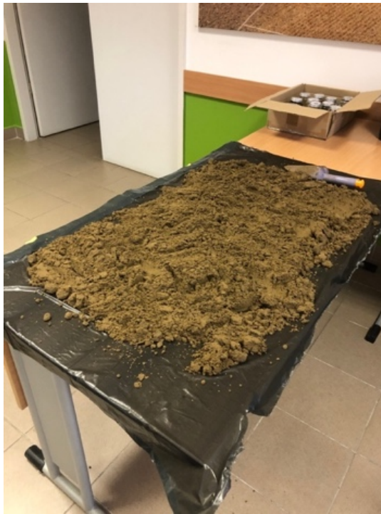
26. ábra A kísérletekhez felhasznált talaj előkészítése a laboratóriumban
