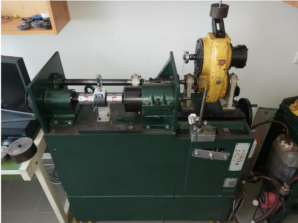
3.20. ábra Az ikertárcsás elven működő hajtásvizsgáló berendezés
