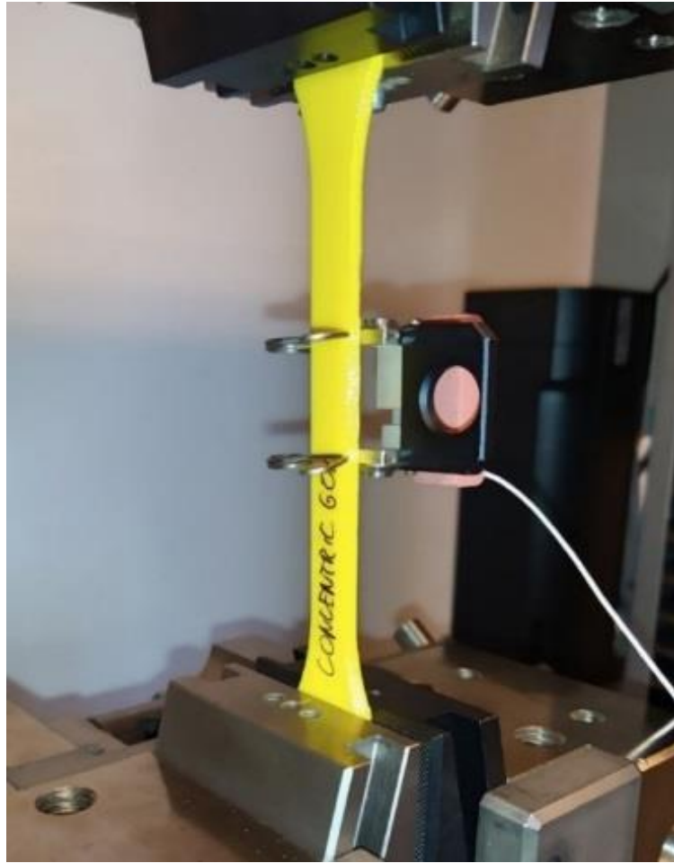
3.7. ábra Az extenzométerrel felszerelt próbatest
