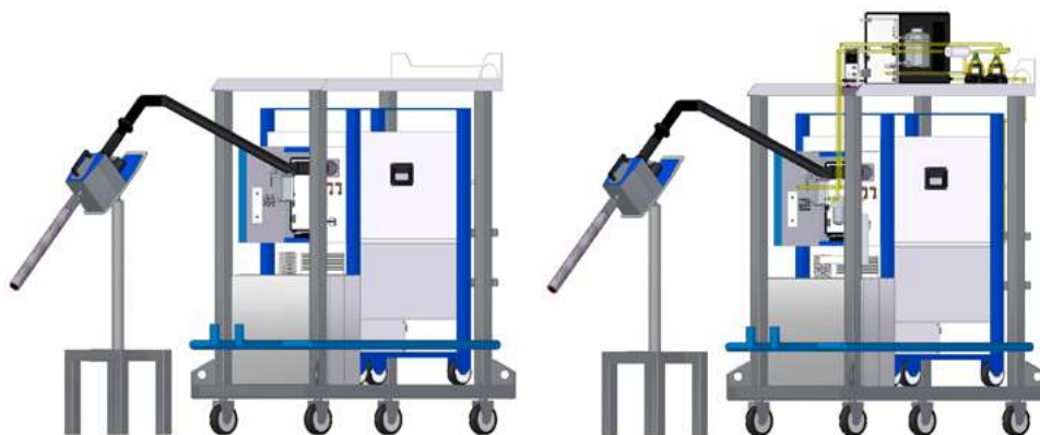
5. ábra Eredeti (balra) és a fejlesztett (jobbra) aeroszol előkészítő egységű kondenzációs részecskeszámoló CAD modellje (Forrás: Bíró Norbert).
