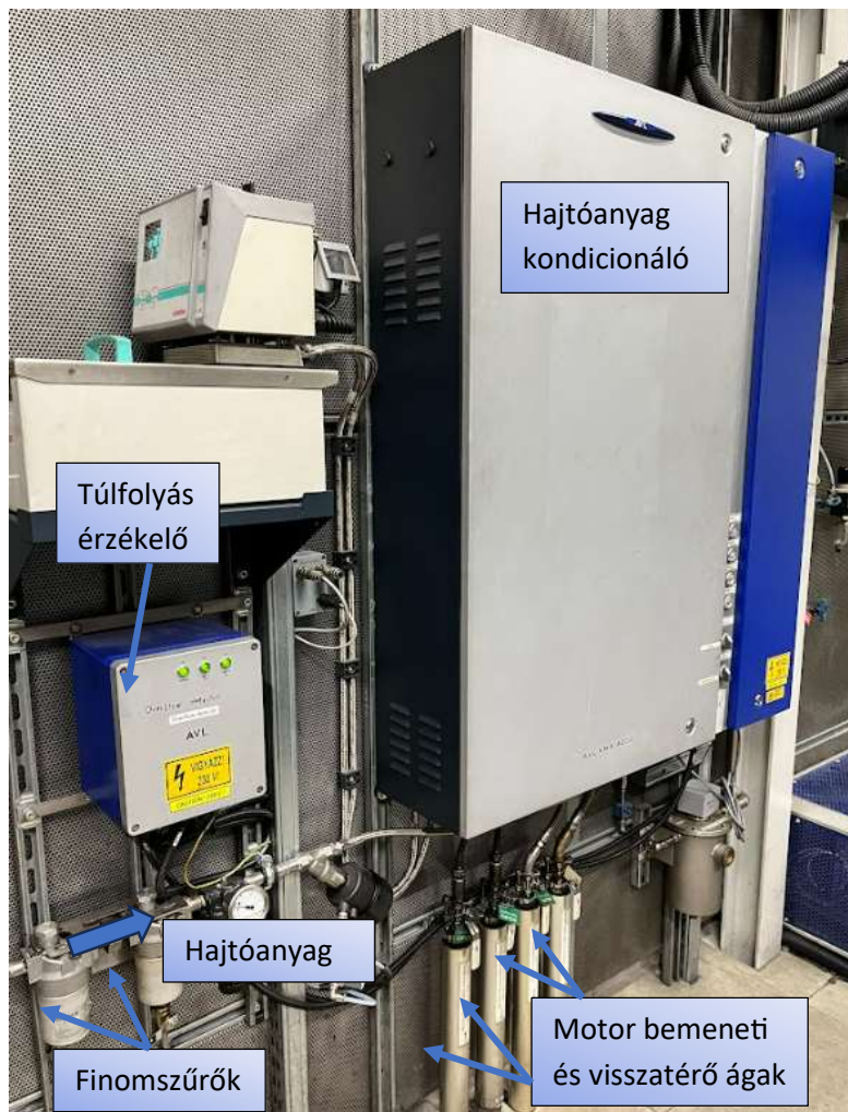
3.10. ábra AVL KMA 4000 hajtóanyag kondicionáló (Forrás: Biró Norbert)
