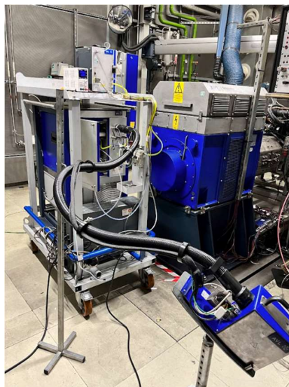
3.27. ábra AVL 489 részecskeszámláló (Forrás: Biró Norbert)
