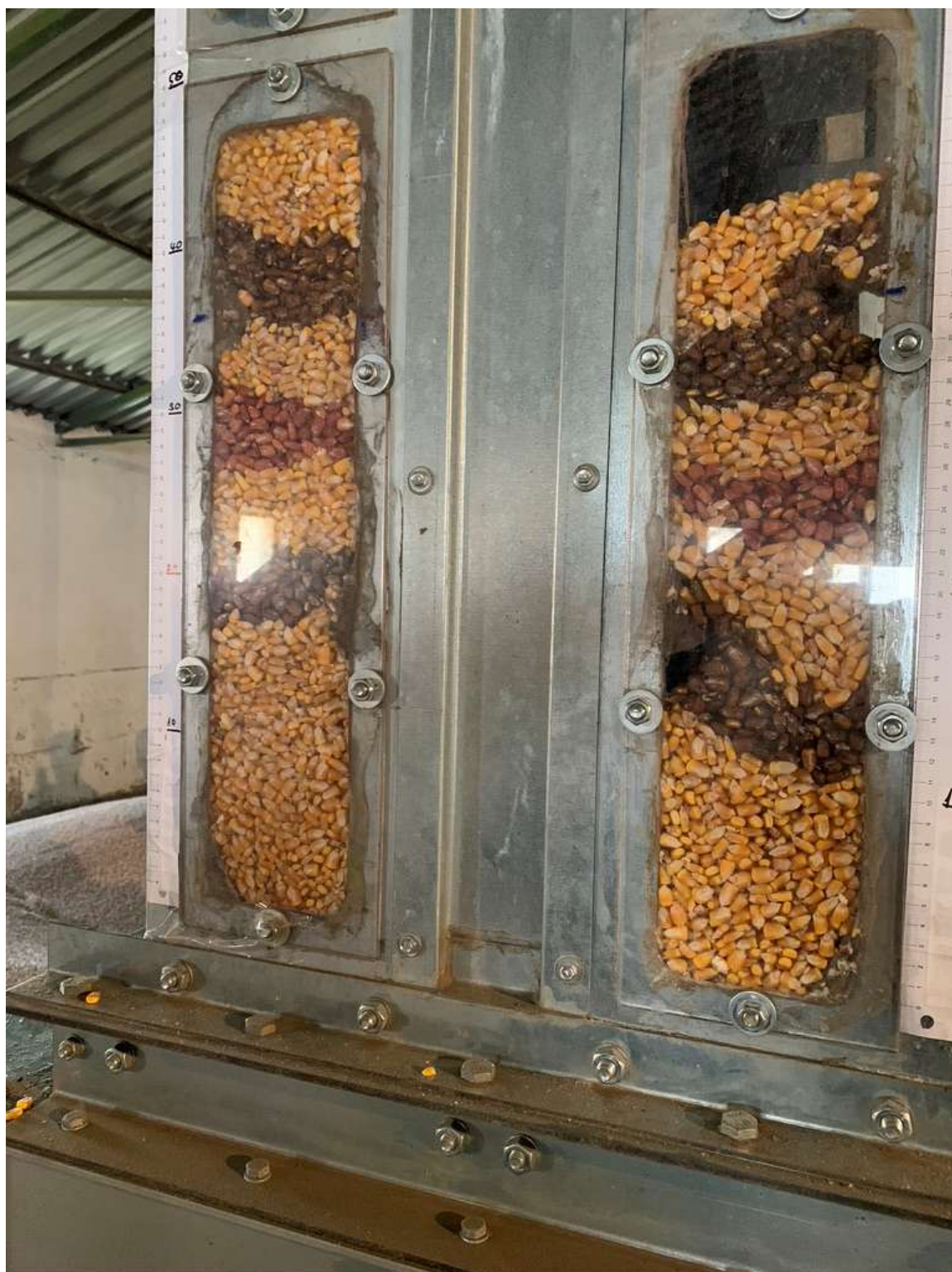
3.10. ábra: A festett csíkok torzulása az egyenetlen anyagáram hatására
