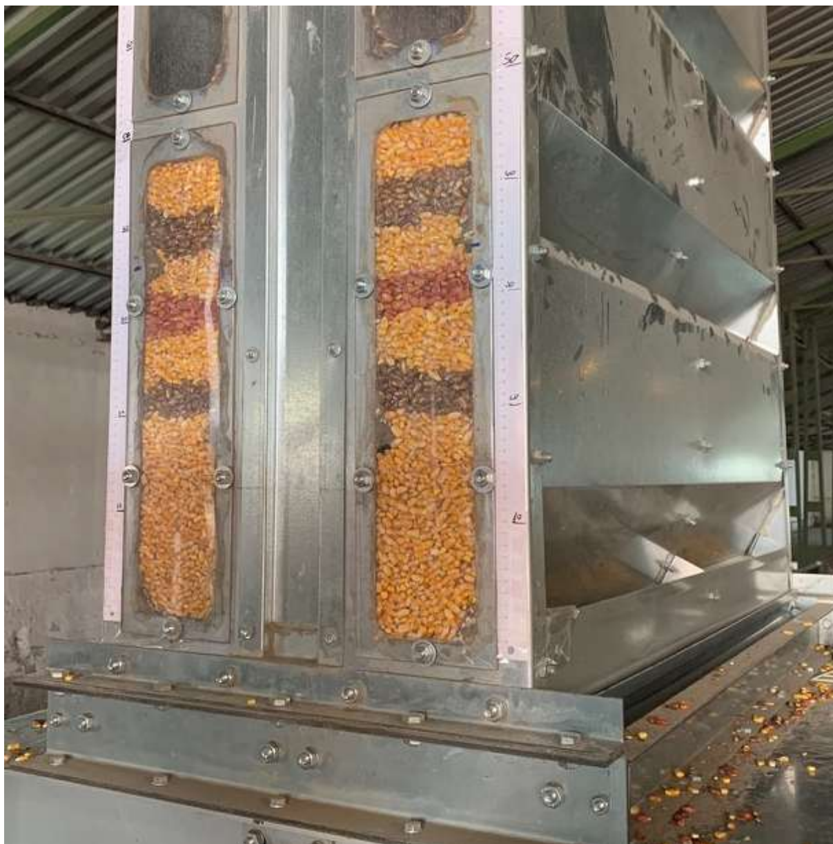
3.9. ábra: Mérés a modellszárítón, festett csíkok
