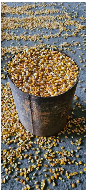
3.18. ábra: Kukorica rézsűszögének mérése acélhenger segítségével
