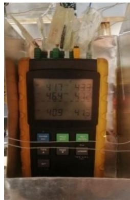
Fig. 3.18. LUTRON BTM 4208SD data logger
