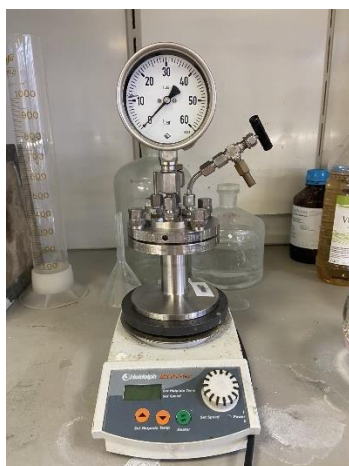
6. kép: Nyomástartó hidrogénező készülék (készítette: Alekszi-K. Anna)
