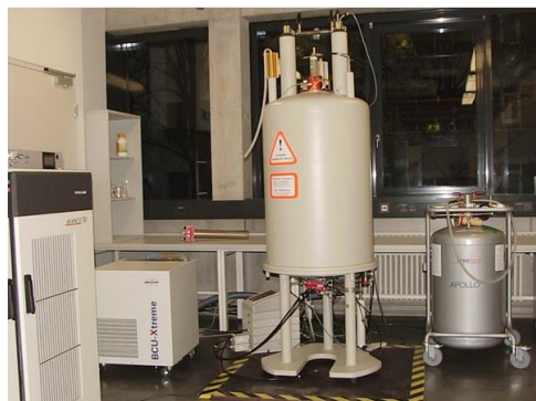
8. kép: NMR készülék (forrás: internet)
