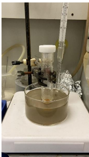
2. kép: Melegítést igénylő reakció elrendezése (készítette: Alekszi-K. A.)
