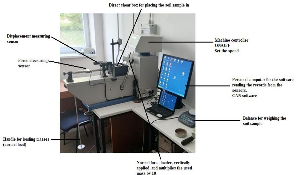
**Fig. 3.1.** Direct shear test (ELE 26-2112/01).
