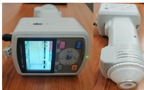
**Fig. 2.1.** Spectrophotometer CM-700d.
