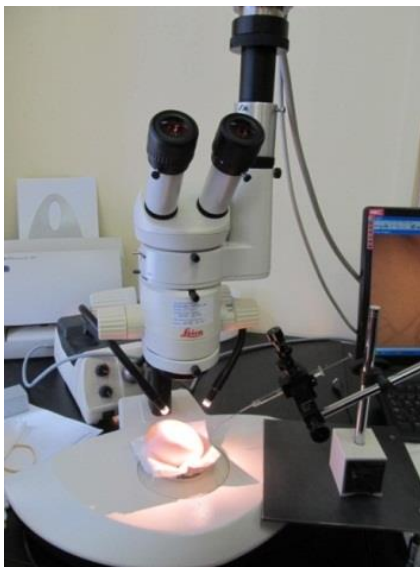
11. ábra: Kamerával és mikromanipulátorral felszerelt mikroszkóp az injektáláshoz
