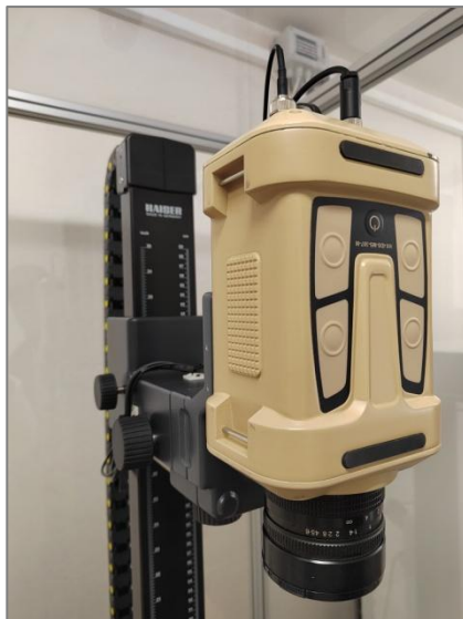
1. ábra. A 2020-tól használt egyedi építésű hőkamera
