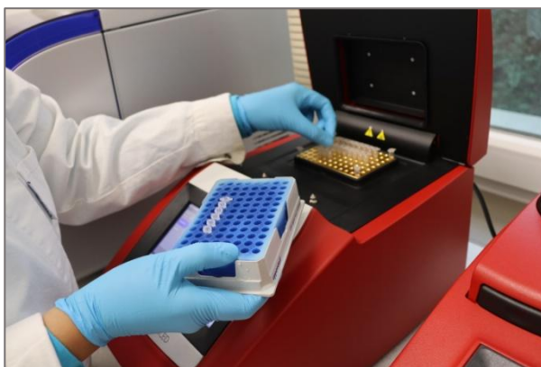
6. ábra. Búzaminták bekészítése DNS vizsgálathoz Biometra TAdvanced PCR készülékbe a tápiószelei génbank genetikai laboratóriumában
