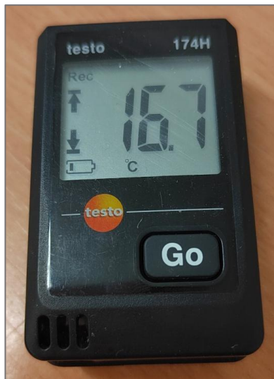
8. ábra. A mérési helyszíneken a hőmérséklet és páratartalom mérésére használt Testo 174 H készülék
