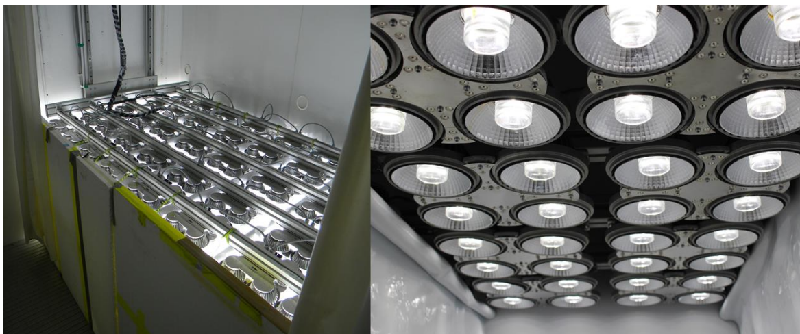
4. ábra A moduláris LED fénymenyezettel elátott PGV-36-os fitotron kamra belső elrendezése, valamint a LED modulok közeli képe, kizárólag fehér fény kibocsátása esetén (saját fotó).
