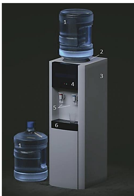
4. ábra Ballonos vízadagolók felépítése. 1: ballon, 2: légszűrő, 3: hideg és meleg vizet tartalmazó tartályok (a készülék belsejében), 4: csővezeték (a készülék belsejében), 5: hideg és meleg csapok, 6: csepegtető tálca. (3D grafika: Pavel Zosim. A szerző engedélyével).
