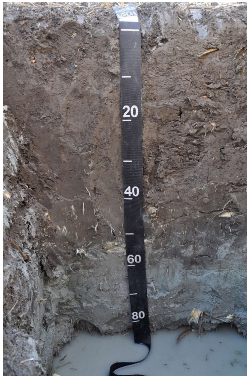
1. ábra. A mintaterület keleti végében feltárt talajszelvényen jól láthatóak a mélységi reduktív viszonyok, illetve a felszíntől 1 m-en belüli talajvízszint.
